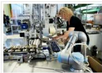
Una nuova generazione di robot è entrata in molte aziende appartenenti ai settori più diversi, dall'automotive al settore meccanico, a quello alimentare. Si tratta dei robot collaborativi, ovvero macchine complesse che operano fianco a fianco con l'uomo coadiuvandolo nel processo lavorativo.
